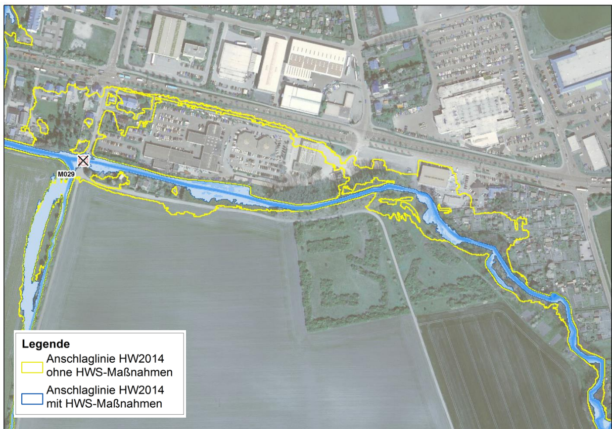
Abbildung 8-20 HW 2014 mit Hochwasserschutzmaßnahmen, Linderbach Weimarische Straße
